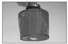
29. Install the K&N<sup>®</sup> Drycharger<sup>®</sup> and hose clamp onto the K&N<sup>®</sup> air filter.
