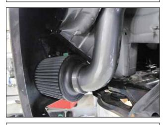
I. Install the AEM<sup>®</sup> Dryflow<sup>™</sup> air filter.
